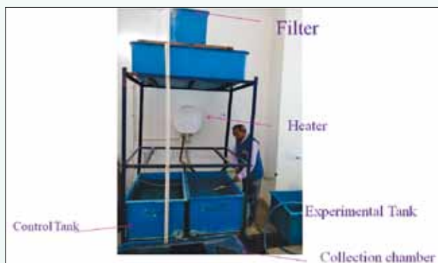
चित्र 44 : प्रयोग के लिए डिजाइन एवं निर्माण किया गया जल पुनः परिसंचारी तंत्र
